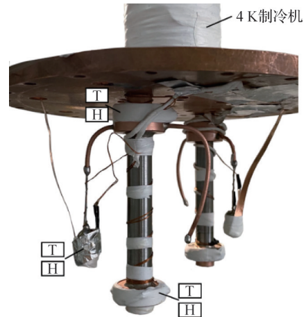
图8 气隙式热开关性能测试装置实物
